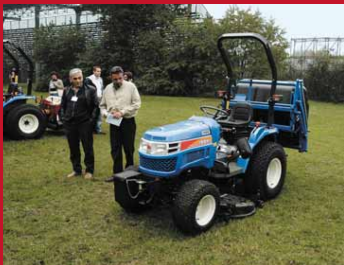
A sinistra, trattore compatto Iseki TM 3240, con apparato di taglio da 122 cm e raccolta idraulica. Sopra, tosaerba Toro Groundmaster 400 all'opera; la larghezza di taglio totale è pari a 335 cm.
